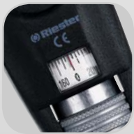
La raya y el punto se giran 360° con el tornillo moleteado. El ángulo se lee directamente en la escala.
